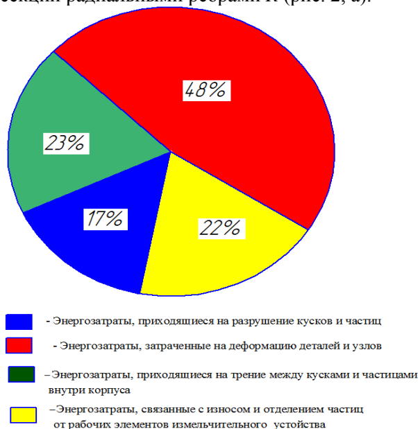
Рис. 1. Диаграмма баланса энергозатрат при измельчении материала
